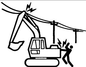
Nunca acercarse a las líneas de alimentación eléctricas con ninguna parte de la máquina y su carga a menos que se cumplan las normas de seguridad locales y nacionales al respecto. Puede producirse una electrocución y la muerte debido a un arco voltaico, al tocar o incluso estar cerca de una máquina en contacto con o junto a una fuente de alimentación eléctrica.
