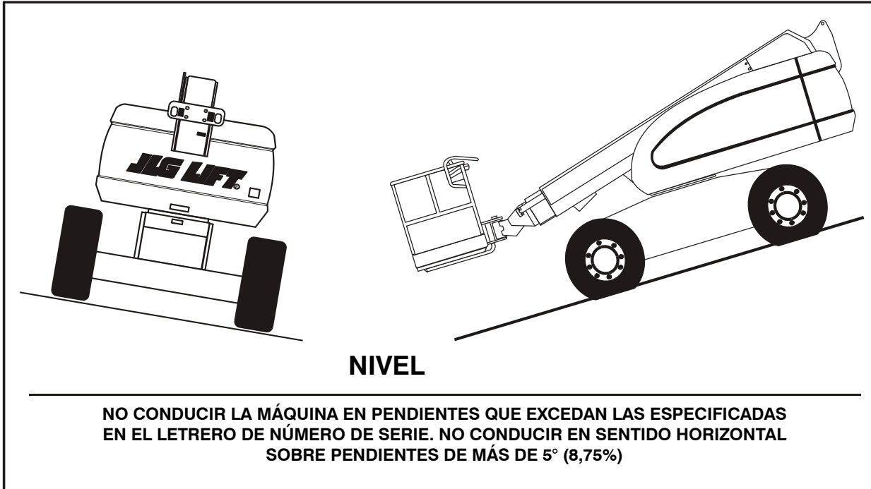
Figura 4-3. Pendiente y pendiente lateral
