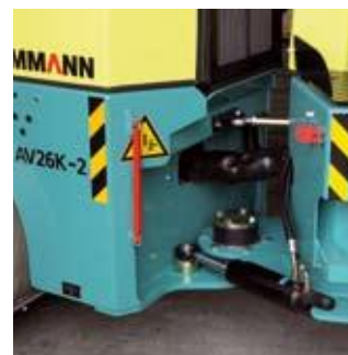
Articulación central lubricada de por vida
